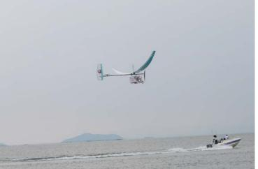
この大会は、滋賀県彦根市の琵琶湖東岸にて自作人力飛行機による飛行距離および飛行時間を競うもので、7 月 29 日 (滑空機部門)、30 日 (人力プロペラ機ディスタンス部門) の 2 日間開催。「Team Birdman Trial」は 1996 年に設立されてから今年で 20 回目の出場で、5,000mの飛行を目標としていました。2016 年度は飛行直後に翼が折れ 24.27mの飛行に終わったものの、2017 年度は高度回復をテーマとした機体設計とし、過去最高記録であった 3,044m から 2 倍以上記録を伸ばしました。
