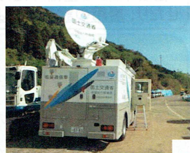
衛星通信車による画像伝送支援(阿蘇大橋付近)
